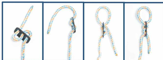
**Последовательная схема фиксации шнура вар. №2.**
